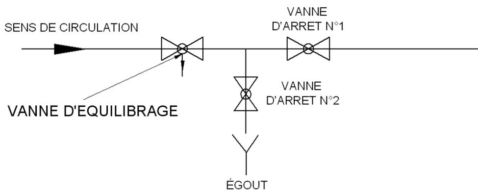
En fonctionnement normal, la vanne d'arrêt N°1 est ouverte et la vanne d'arrêt N°2 est fermée. Pour l'évacuation des particules à l'égout, on ferme la vanne N°1 et on ouvre la vanne N°2.
