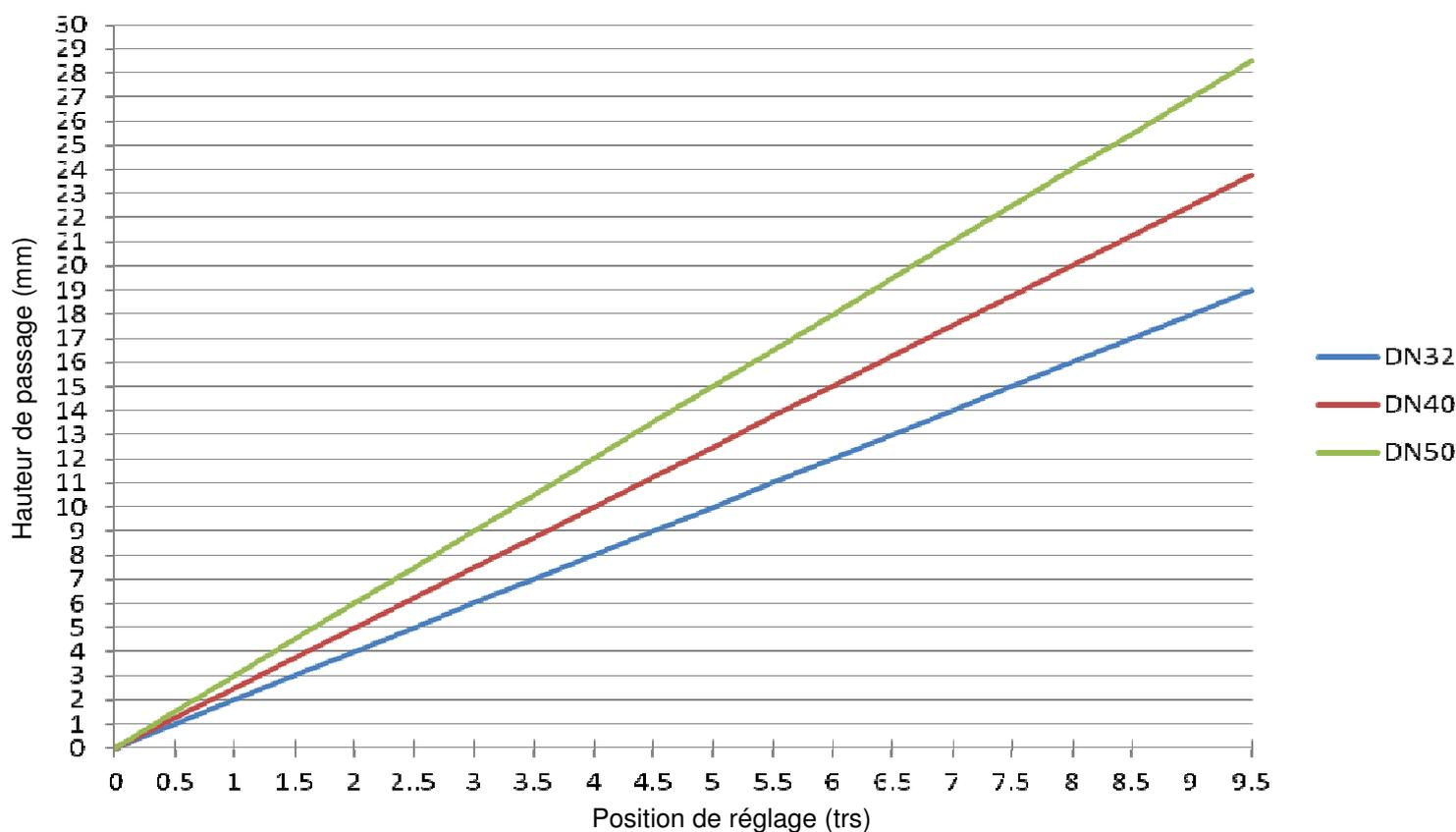
**Exemple de lecture :** En position 4.0, la vanne GRK en DN32 à une hauteur de passage de 8mm pour un Kv de 5.24 et la vanne GRK en DN40 à une hauteur de passage de 10mm pour un Kv de 8.45
