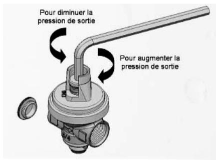
Pour modifier le réglage, dévisser la vis entièrement, ouvrir un robinet afin de permettre un écoulement, et opérer le réglage désiré en revissant la vis de réglage. Après le réglage, bien resserrer le bouchon moleté afin de garantir l'étanchéité de l'appareil.
