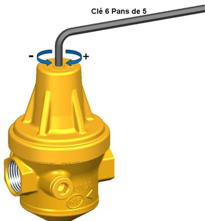
Pour augmenter la pression, introduire une clé Allen de 5 au niveau du haut du chapeau. Visser jusqu'à l'obtention de la pression désirée. Pour diminuer la pression, dévisser complètement la vis de réglage, ouvrir un robinet afin de permettre un écoulement et abaisser la pression dans le réseau. Refermer le robinet et visser jusqu'à l'obtention de la pression désirée. Le réducteur est réglable de 1 à 5 bar en aval pour une pression d'entrée de 8 bar.
