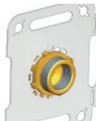
2 Passer dans les trous les tuyaux multicouches et installer les coudes.
