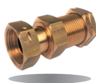
Raccord compteur télescopique. Avec écrou tournant percé (trou de plombage) et fourni avec 2 contre-écrous.
